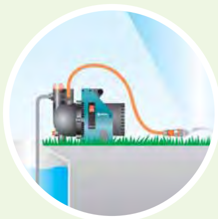
Studnia lub cysterna o wysokości zasysania do 8 m
